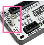
**Schraubbefestigung** ermöglicht die Befestigung der lococube® mit zwei Schrauben.
